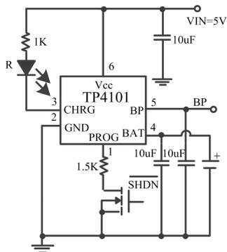
图 1: 可信号控制充电电路
