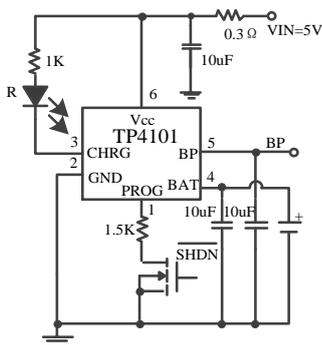
图 1: 可信号控制充电电路
