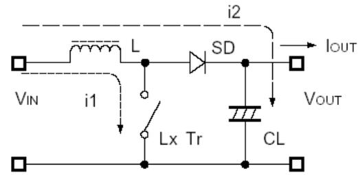
升压电路在没有充电电源接入且锂电池电压在 3V-4.2V 时，升压电路自动启动，持续输出 5V 恒压源。另当 BAT 电压在 3V-4.2V 时，且输入电源  $V_{CC}$  小于 3.8V，或  $V_{CC} < V_{bat} + 50mV$  以及 PROG 端悬空时，升压也会工作。升压电路带有锂电池低压保护功能，当锂电池电压低至 3V 时，TP5400 会自动关断升压。
