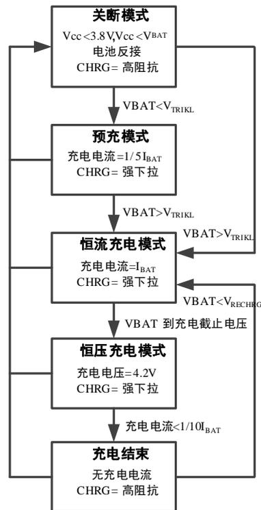
图 5 一个典型充电循环的状态图
