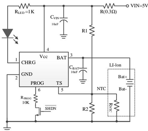
图 3 可信号控制充电电路
